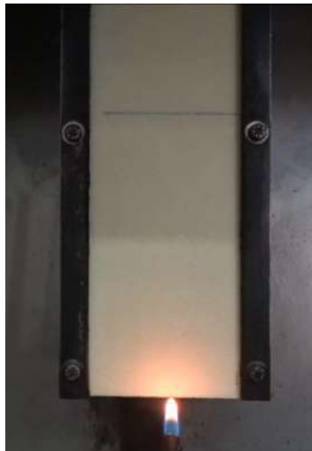
Fotografia 8 – Ensaio com o queimador aplicado na borda do corpo de prova.
