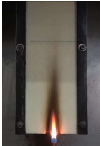
Fotografia 9 – Chama não atinge a marca de 150 mm.
