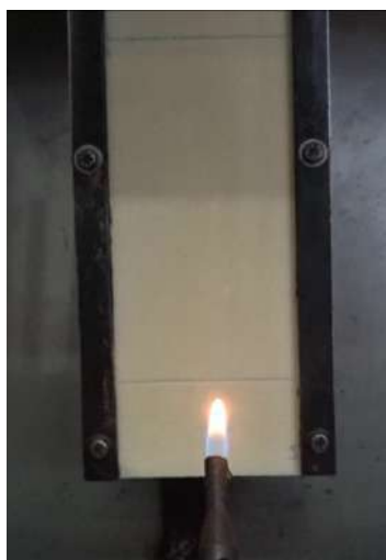
Fotografia 10 – Ensaio com o queimador aplicada na superfície do corpo de prova.
