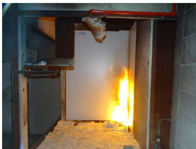
Fotografia 13 – Realização do ensaio de reação ao fogo.
